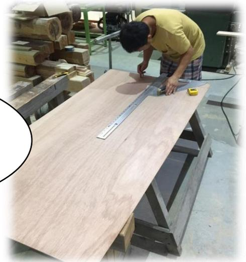
「墨壺」という壺に入れた墨を使って、加工する箇所を目印をつける「墨付け」という作業をします。この目印に合わせて、大工は木材を加工していきます。その加工のことを、「刻み（きざみ）」と言います。
